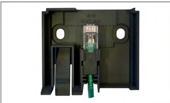
2.c. RJ-45 liittimen yläosan tulee olla seinäkiinnikkeen katkoviivan tasalla. Spacer sopii liittimen ja vedonpoiston väliin.
