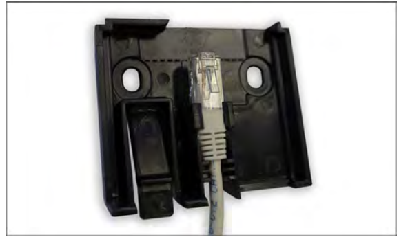
2.a. RJ45 liittin asennetaan seinäkiinnikkeeseen siten että liittimen yläosa on katkoviivan tasalla. Vapautus kytkin asetetaan pois päin seinästä.
