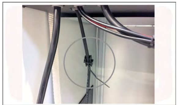
Spacer kappale on kiinnitetty koneessa kiinni olevaan LAN kaapelin (Suurimman peltikuoren alla).
